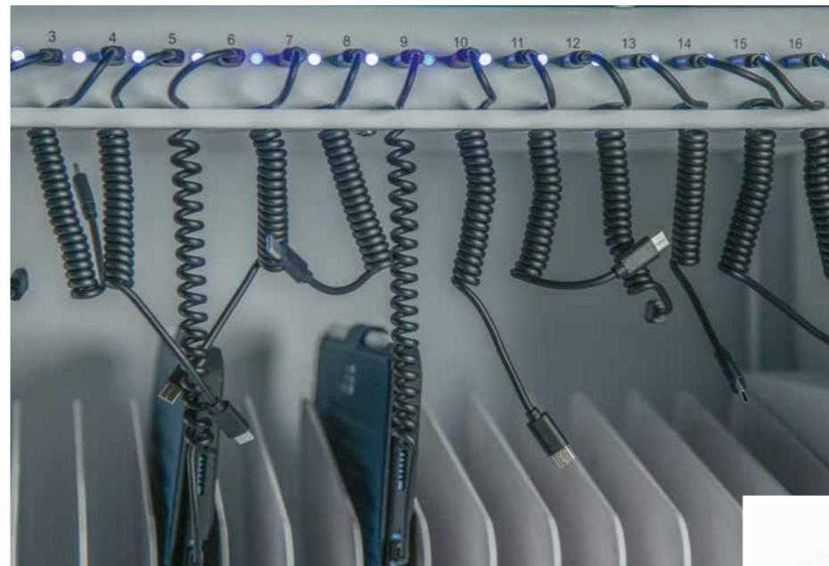
Die LED-Leuchte bietet die Möglichkeit, den Ladestatus jedes Ladeanschlusses anzuzeigen, unabhängig davon, ob eine Aufladung stattfindet oder nicht. Sobald die Ladebox mit Strom versorgt ist, leuchten die LEDs in Weiß. Während des Ladeprozesses leuchtet die LED in Blau, um anzugeben, dass ein Gerät geladen wird.
